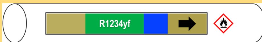
Figura 5 – Exemplo da “Identificado por Etiquetagem” em tubagem pintada com “cor de base/decorativa” prescrita no DNP Guia 5:2016 e em que o fluido frigorigéneo é inflamável
