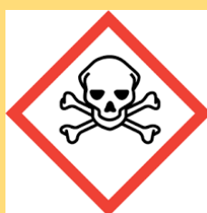
Figura 8 – Pictograma «GHS06» para Toxicidade aguda (via oral, cutânea, inalatória), categorias de perigo 1, 2, 3
