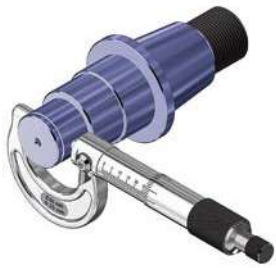
Verificação dimensional de um veio utilizando um micrómetro de exteriores.
