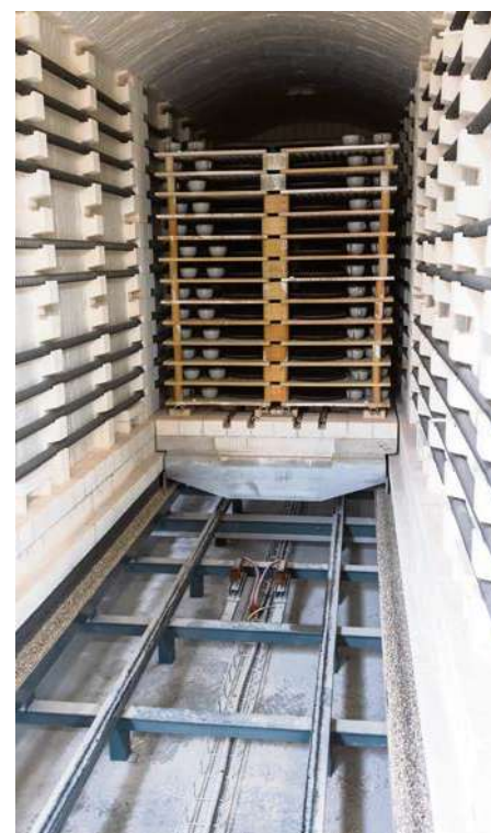
Detalhe do interior de um forno intermitente 100% elétrico.
