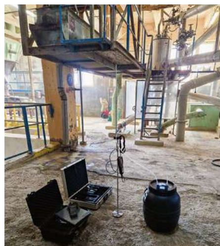
Recolha de amostras de ar para determinação de odor.
