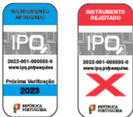
Figura 10 – Etiquetas informativas de controlo metrológico legal, a utilizar em 2022, em taxímetros, sonómetros e manómetros
