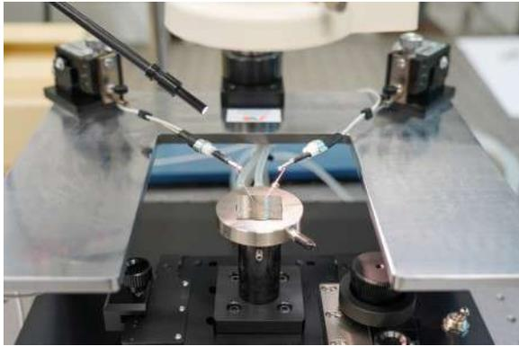
Figura 1 – Manipulação do *Memristive device* com microscópio
