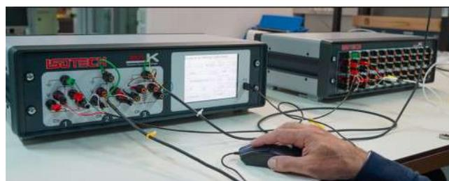
Figura 7 – Ponte de medição de elevada exatidão no domínio da temperatura
