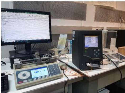
Figura 4 – Sistemas experimentais para a medição de microcaudal
