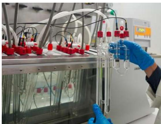
Figura 3 – Sistema primário de medição de pH – célula de Harned
