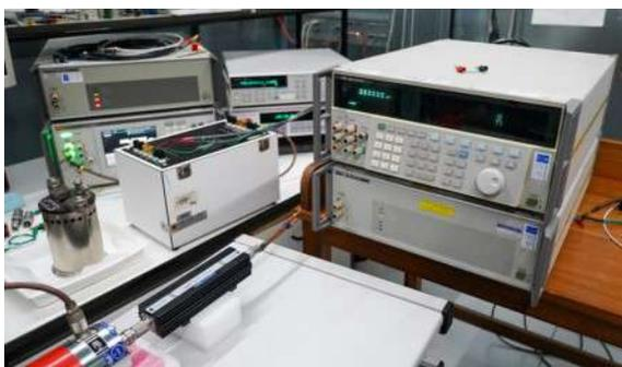
Figura 6 – Sistema experimental para calibração multifunção de grandezas elétricas
