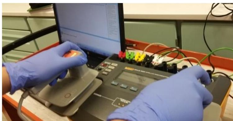
Figura 9: Verificação das pás e do cabo ECG.
