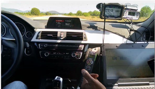
Figura 2 - Interior do veículo alvo: podem observar-se os mostradores dos recetores GNSS, também utilizados na medição da distância.
