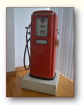
Este equipamento, produzido por "TOKHEIM Oil Tank and Pump Co.", é uma bomba medidora automática "para gasolina, petróleo e gasoil", de acionamento contínuo por motor elétrico, para medição em litros por leitura em duas janelas opostas até 999 litros e regresso a zero para cada medição, pelo acionamento de uma manivela.
