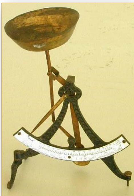
A balança, construída em latão e ferro, tem um prato fixo e está assente em três pés, um dos quais tem um parafuso ajustável para garantir o seu equilíbrio.
