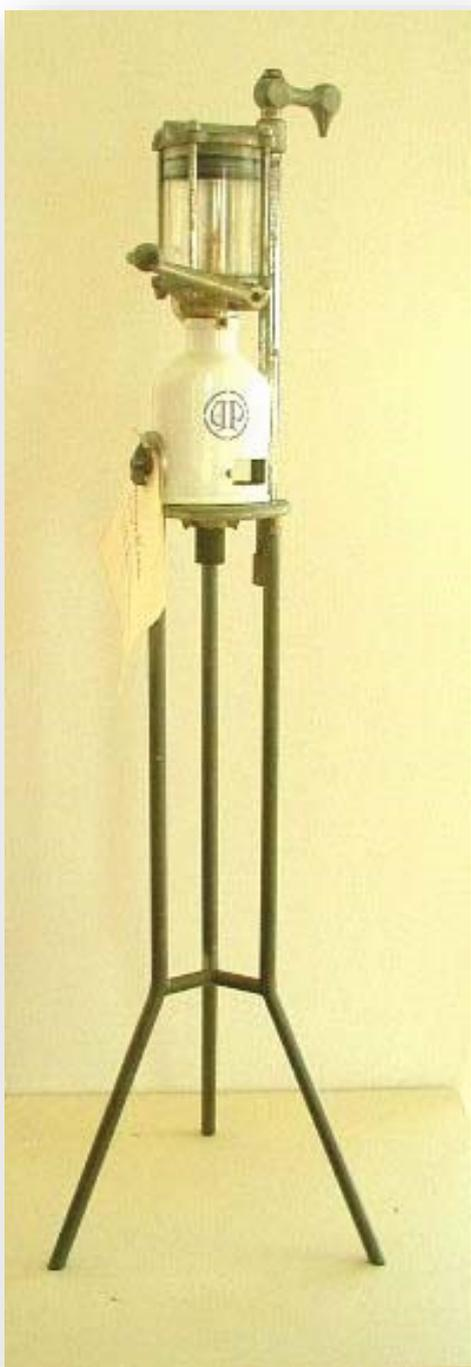
Este instrumento é constituído por um sistema de bomba e está assente num tripé. O azeite seria depositado num depósito de porcelana e posteriormente bombeado através de uma manivela. O tripé é construído em metal e sobre o depósito de porcelana encontra-se um reservatório em vidro. No depósito de porcelana, sobre um fundo branco, estão pintadas as letras "AP", formando o logotipo típico do fabricante: "António Pessoa".
