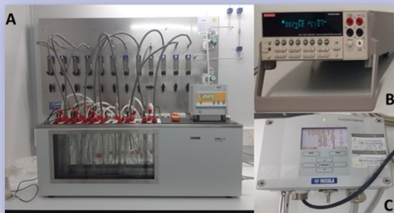
Sistema potenciométrico primário: A – Banho de água termostabilizado; B – Multímetro e C – Barômetro
